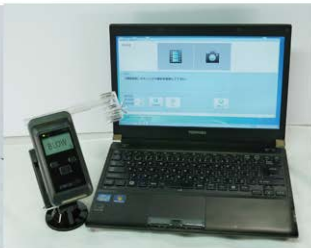
AC-015ST II (AC-015 とパソコンとの接続)
