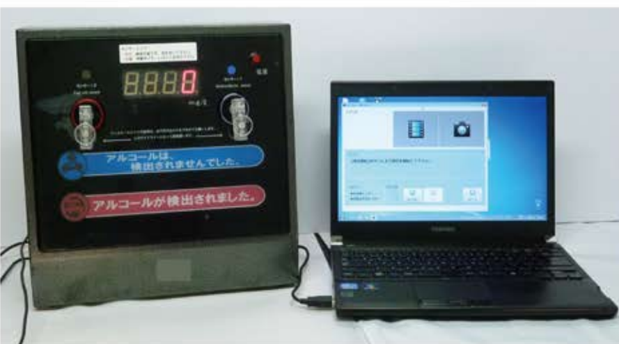
AC-011ST II (AC-011 とパソコンとの接続)
